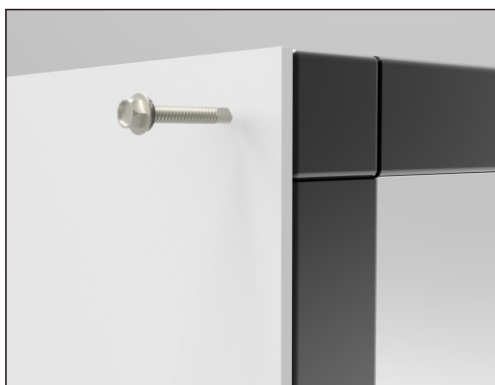
1.使用自攻螺丝将背板安装至龙骨架上
