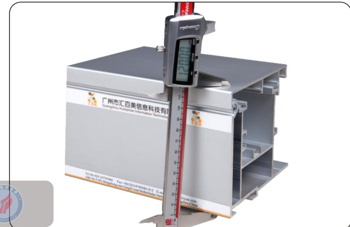
工程加强版灯箱铝型材三边受力壁加强至3.0-3.3mm厚，灯箱受力更均匀牢固，大尺寸灯箱承重受力不变形。
