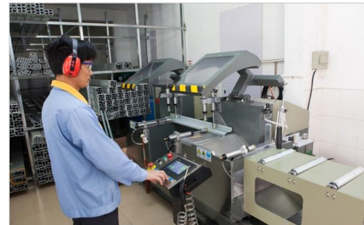
引进全自动数控切割机切割铝型材, 精准切割各种角度拼接各种形状符合不同工程的安装需求。
